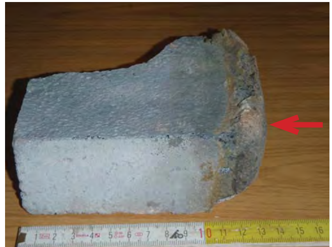
Bild 4: Abzehrung der „neuen Taillensteine“ nach nur einer Betriebsperiode.
