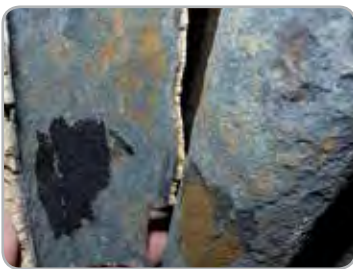
Abb. 1: Überhitzerrohre aus 16Mo3 nach ca. 1.500 h Betrieb, TRG= ~ 650 °C; TOF= ~420 °C
