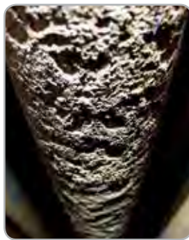
Abb. 1: Überhitzerrohre aus 16Mo3 nach ca. 1.500 h Betrieb, TRG= ~ 650 °C; TOF= ~420 °C
