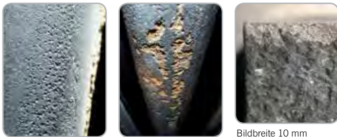
Abb. 5: Der Korrosionsangriff an dieser thermischen Spritzschicht erfolgt muldenförmig, durch Salzschmelzen (schadensverursachend). Die Korrosionsfront schreitet gefügeübergreifend in den Werkstoff voran. Trotz guter Applikation (dicht, ausreichende Haftung) ist die Schicht chemisch nicht resistent gegenüber Salzschmelzen.
