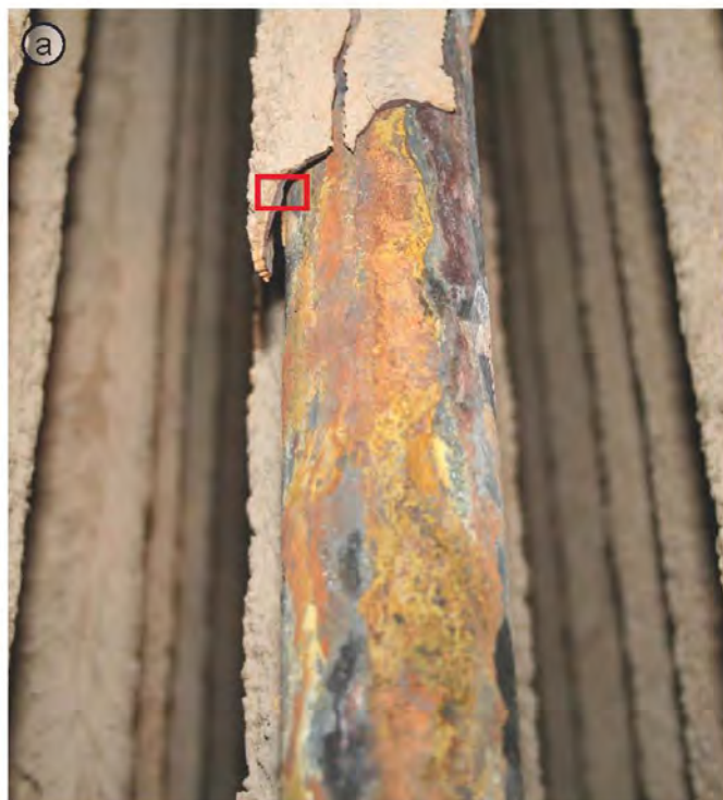
Bild 5: Optische Bewertung der Werkstoffoberflächen im verschmutzten Zustand: a) dickere Korrosionsbeläge zeigen verstärkt korrosive Angriffe; b) anhand von Belagsuntersuchungen können die korrosiv wirkenden Phasen an der Korrosionsfront sowie die Korrosionsprodukte untersucht werden: c) unmittelbar an der Korrosionsfront ist in diesem Beispiel eine massive Eisenchlorid-schicht zu erkennen, gefolgt von Eisensulfid sowie Salzen und Eisenoxiden.
