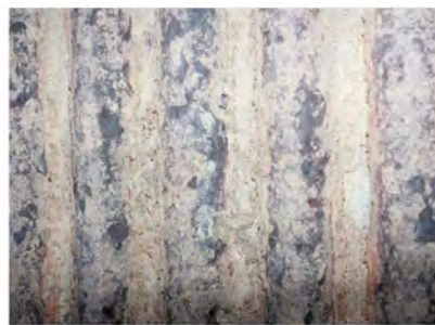
Bild 3: Optische Bewertung der Werkstoffoberflächen im verschmutzten Zustand; die Dicke bzw. die Verteilung der Korrosionsbeläge geben Hinweise auf die Orte mit erhöhtem korrosiven Angriff
