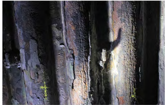
Bild 4: Bei einem Spalt im Wandaufbau der Feuerfestzustellung, z. B. durch mangelnden Verbund von Platten mit der Membranwand, kann hinter den Platten intensive Korrosion der Membranwand stattfinden.
