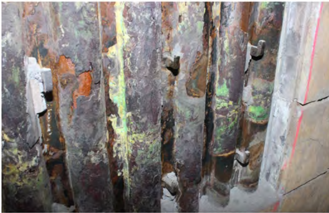
Bild 4: Bei einem Spalt im Wandaufbau der Feuerfestzustellung, z. B. durch mangelnden Verbund von Platten mit der Membranwand, kann hinter den Platten intensive Korrosion der Membranwand stattfinden.
