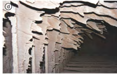
Bild 2: Optische Bewertung der Verschmutzungsverteilung in den verschiedenen Bauteilen, a Brennkammer, b Nachbrennkammer, c Membranwände, d Überhitzer
