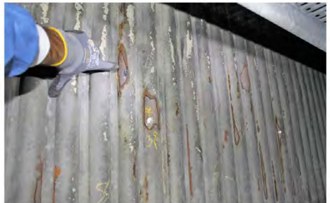
Bild 6: Im gereinigten Zustand können die Werkstoffoberflächen mit streifendem Licht abgeleuchtet und die Messungen der Restdicken an den am stärksten angegriffenen Orten gemessen werden. Somit kann die Restnutzungsdauer der Werkstoffe bestimmt werden.
