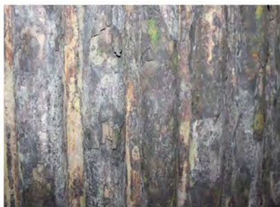
Bild 3: Optische Bewertung der Werkstoffoberflächen im verschmutzten Zustand; die Dicke bzw. die Verteilung der Korrosionsbeläge geben Hinweise auf die Orte mit erhöhtem korrosiven Angriff
