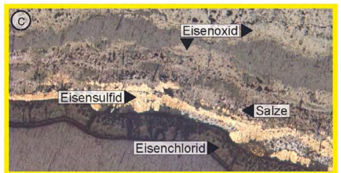
Bild 5: Optische Bewertung der Werkstoffoberflächen im verschmutzten Zustand: a) dickere Korrosionsbeläge zeigen verstärkt korrosive Angriffe; b) anhand von Belagsuntersuchungen können die korrosiv wirkenden Phasen an der Korrosionsfront sowie die Korrosionsprodukte untersucht werden: c) unmittelbar an der Korrosionsfront ist in diesem Beispiel eine massive Eisenchlorid-schicht zu erkennen, gefolgt von Eisensulfid sowie Salzen und Eisenoxiden.
