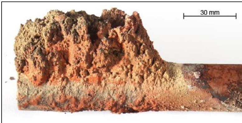
Abb. 2: Belagsbeprobung mit der TRP, Expositionszeit im Rauchgas 890 Stunden bei ca. 1.100 °C. Typischer Belagsaufbau in einem Braunkohlekraftwerk
