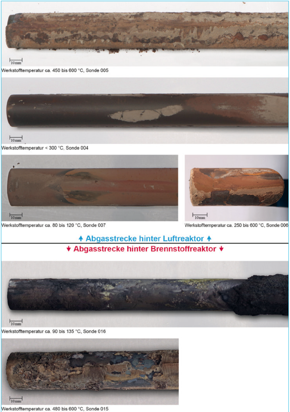
Abb. 3: Makroskopische Sondenbefunde nach der Expositionszeit von ca. 260 h in der Pilotanlage
