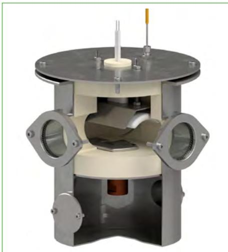
Bild 7: Schematische Skizze des eigenentwickelten Korrosionsversuchsstandes der Firma CheMin GmbH
