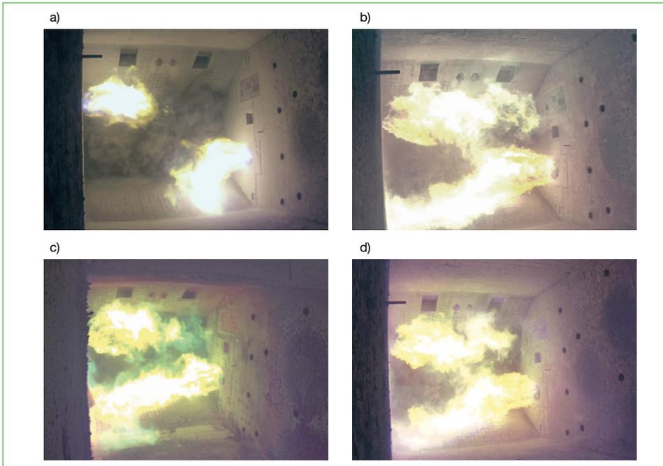
Bild 2: Aufnahmen des Wirbelbetts und der Flambilder der Brenner zu verschiedenen Zeitpunkten: a) Teillastbetrieb der Brenner (9 MW), Anfahrbetrieb mit guter Bettverwirbelung ohne Totbereiche; b) bis d) Volllastbetrieb der Brenner (27 MW) zu verschiedenen Zeitpunkten mit verschiedenen Einstellungen
